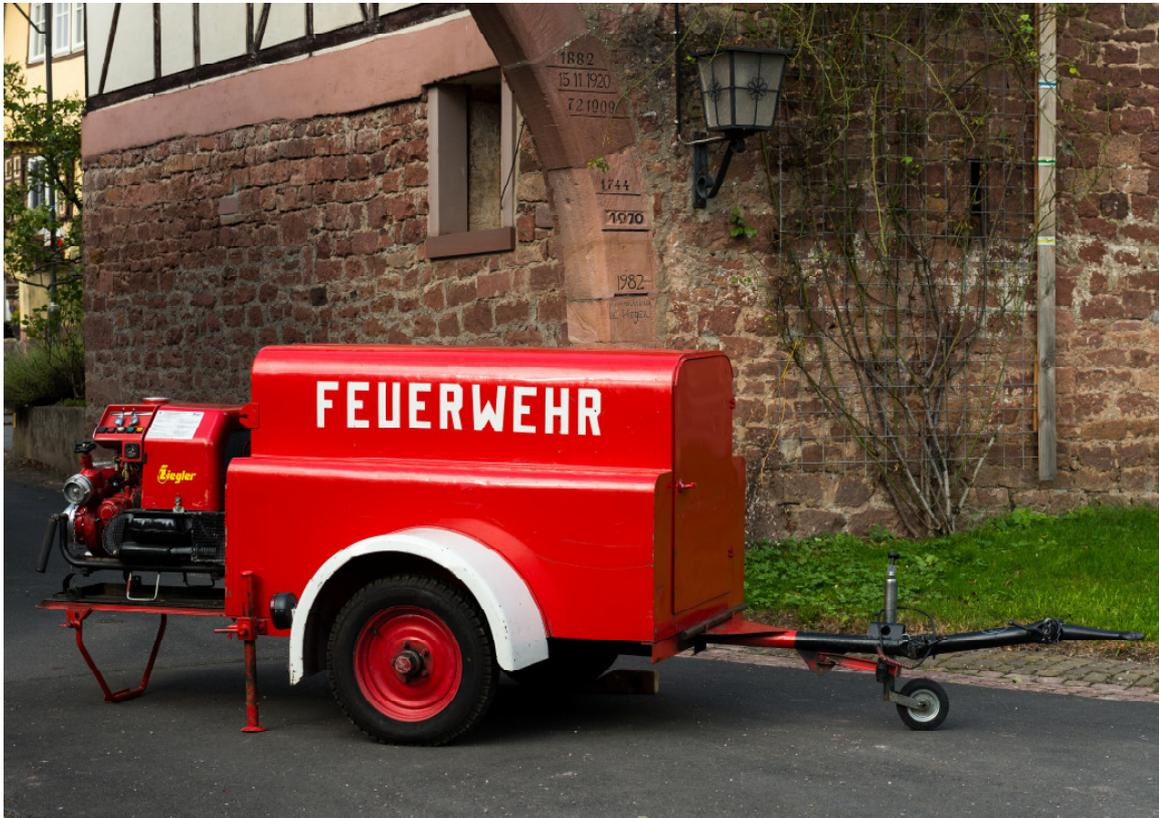
**TSA** (Tragkraftspritzenanhänger) **mit einer FP 8/8** (Feuerlöschkreiselpumpe)
